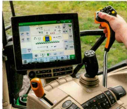
LANDWIRTSCHAFT MIT JOYSTICK Moderne Traktoren und Ackergeräte werden längst digital bedient. Sogar Spurführung auf Zentimeter genau geht: via GPS-Steuerung.
