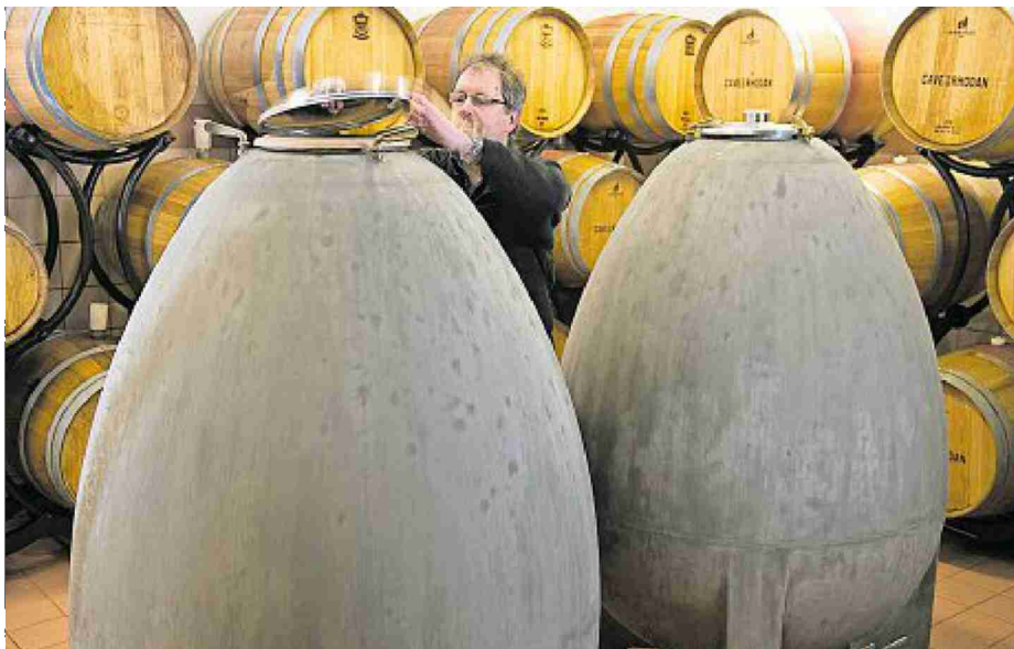
Aus speziell entwickelten Betonmischungen: Weintanks in Ei-Form.
