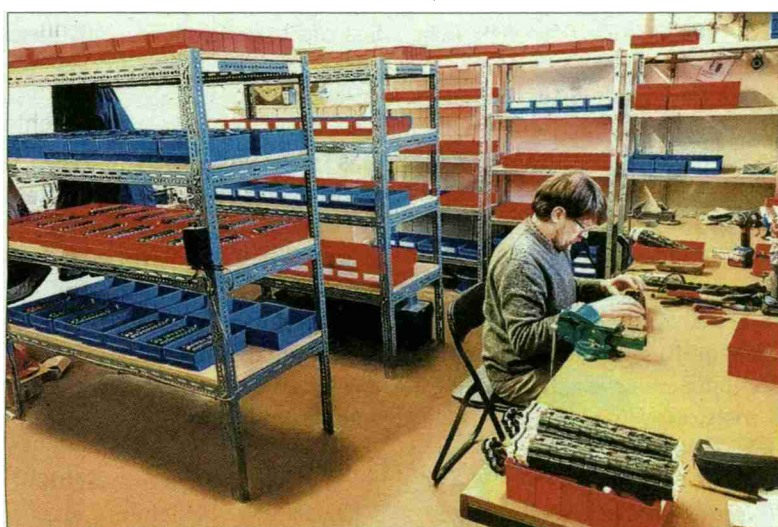
Ein Mitarbeiter von Libattion demontiert gebrauchte E-Bike-Akkus bei Batrec in Wimmis. Bild: zvg
