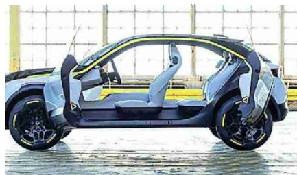
Die Portaltüren öffnen sich elektrisch.
