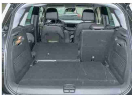
Logeable La capacité du coffre oscille entre 410 et 520 l avec l'option banquette coulissante.
