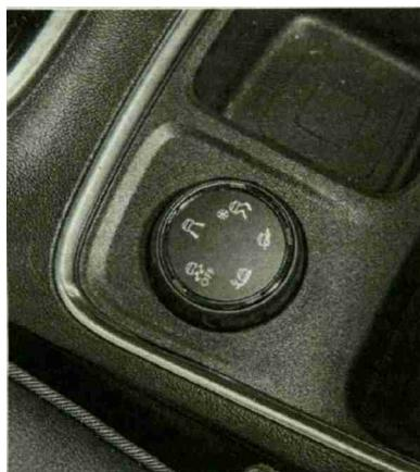
◀ L'IntelliGrip (nom donné au Grip Control de Peugeot) met cinq modes à la disposition du conducteur. En plus d'adapter la répartition de la puissance aux roues avant, il permet le patinage des roues le cas échéant. De plus, il modifie les points de changement de vitesse de la boîte automatique et adapte l'accélérateur.
