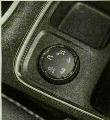
◀ Das IntelliGrip (bei Peugeot Grip Control genannt) bietet dem Fahrer fünf Fahrmodi. Es kümmert sich um die Kraftverteilung zwischen den beiden Vorderrädern, lässt aber bei Glätte etwas Schlupf zu. Das System passt die Schaltpunkte der Automatik an und variiert das Ansprechverhalten des Gaspedals.
