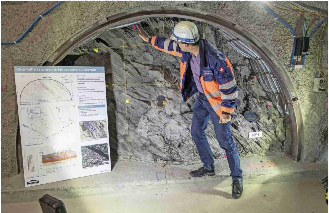
Le chef de projet détaille une zone de faille, prouvant que la roche est particulièrement broyée et que sa perméabilité est complexe. JEAN-PAUL GUINARD
