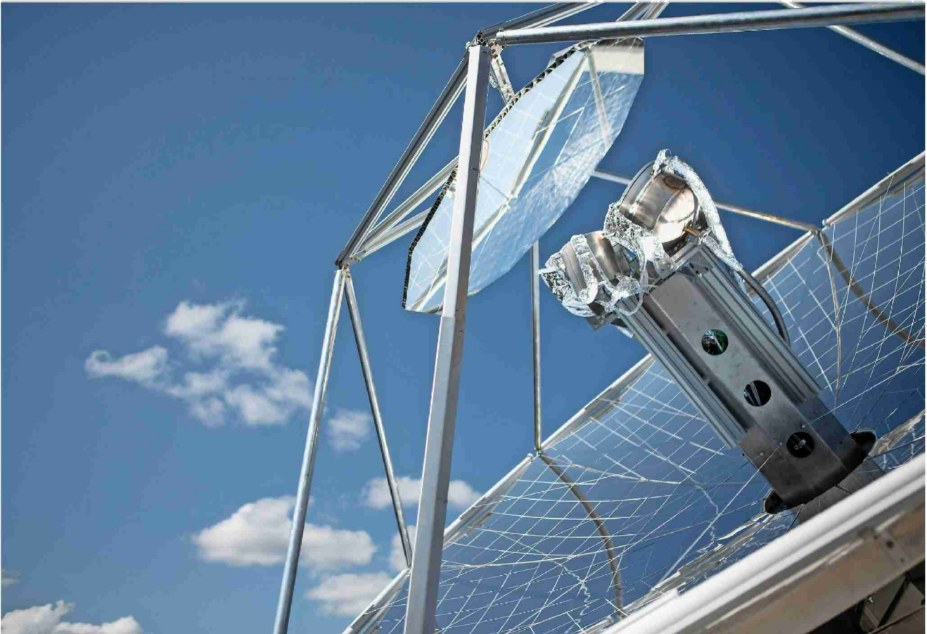
Das Heizsystem auf dem Dach der ETH Zürich liefert die Wärme, um aus CO 2 , Wasser und Sonnenschein flüssigen Treibstoff herzustellen. Fotos: Sabina Bobst
